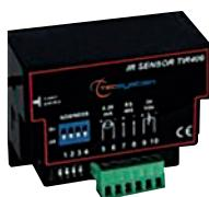
La centralina NT935-IR AD, accoppiata ai sensori infrarossi dedicati TIR409, permette di effettuare il controllo della temperatura senza contatto fisico tra la sonda e la superficie da misurare. Tale caratteristica la rende indispensabile per il monitoraggio termico di avvolgimenti in media o alta tensione, ove l'utilizzo di sensori PT100 non è consigliato o permesso a causa dei problemi di isolamento elettrico e quindi di sicurezza.
