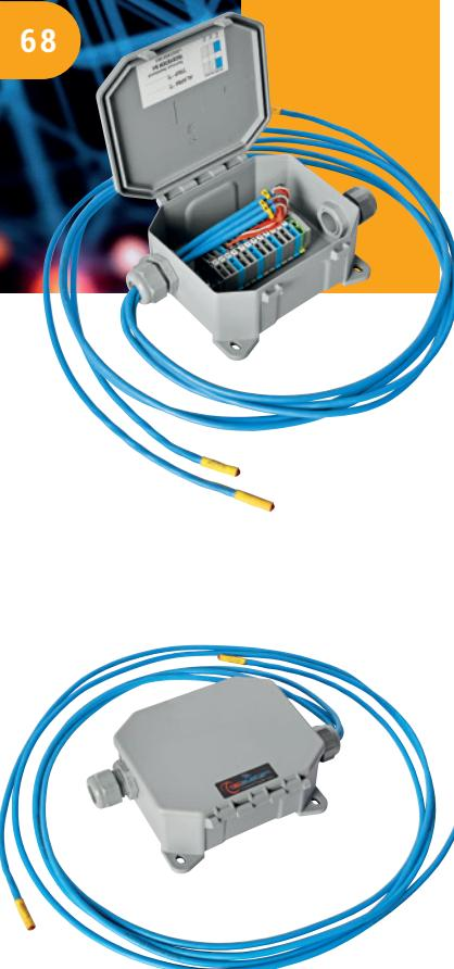
La **SCS-R** è una scatola di derivazione, studiata e realizzata dalla TECSYSTEM, che consente l'installazione rapida, sicura ed economica delle termosonde preposte al rilevamento della temperatura dei trasformatori incapsulati in resina.
